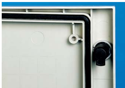
Polyuretanové těsnění. Perforovaný rastr 25 mm na dveřích pro usnadnění montáže příslušenství. Úhel otevření dveří: 180 °.
