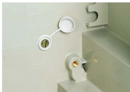
Přímé uchycení rozvodnice na stěnu dnem s krytkou zajišťující dvojitou izolaci a utěsnění.
